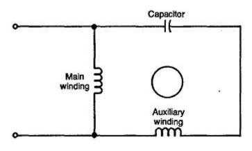
Figure 3: PSC motor wiring<sup>1</sup>
